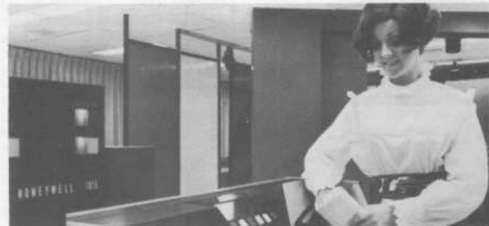
Honeywell en Bull werken al heel lang samen bij de ontwikkeling en productie van mainframes. Dat blijkt onder meer uit deze Honeywell Bull Serie 200 1015 uit de jaren zestig: de tijd van de magneetkerngeheugens en verwerkingssnelheden van 0,6 Mips.
