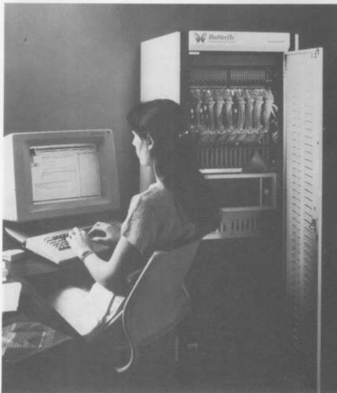
Een van de weinige kubussystemen die op dit moment op de markt zijn is de Butterfly van BBN, een computer die is uitgevoerd met 256 68020-processoren.
